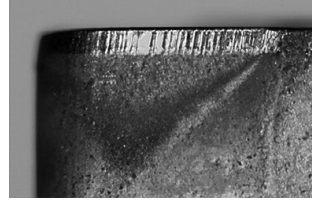
Boşluk yüzeyinde aşınma
