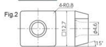
SDHW1204PDTR (ブレイカなし Without chipbreaker) (材種 Grade: JC8015)
